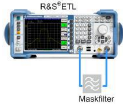
Рис. 24 Измерение частотной характеристики фильтра-маски
