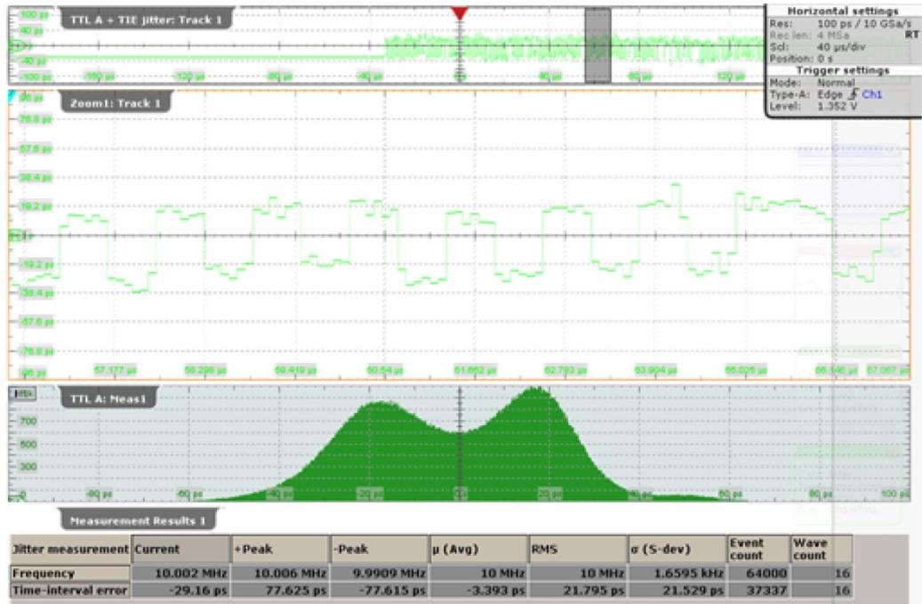
Рисунок 4-18 – Масштабирование джиттера TIE
