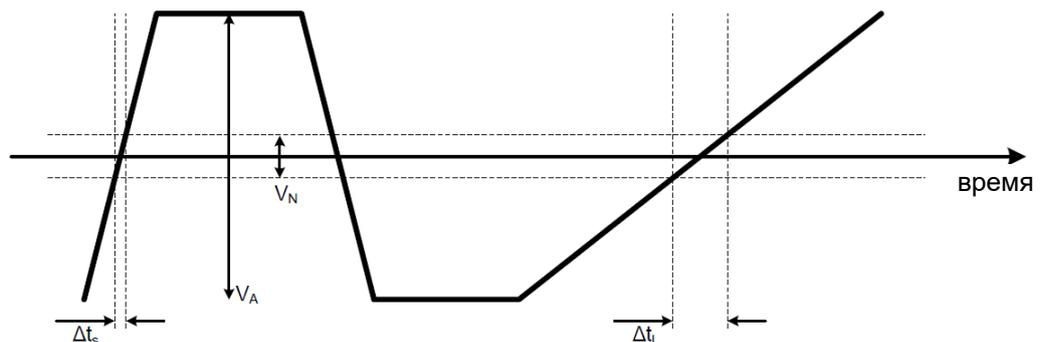
Рисунок 2-11 – Влияние шума на точность измерений времени
