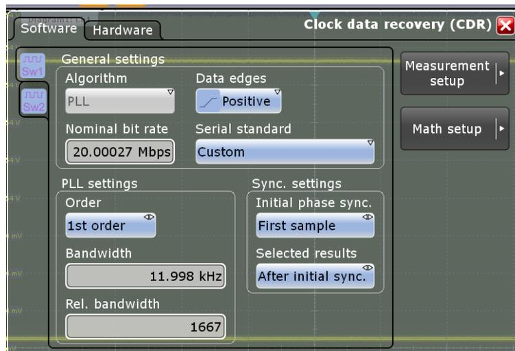
Рисунок 4-16 – Настройка программной функции CDR
