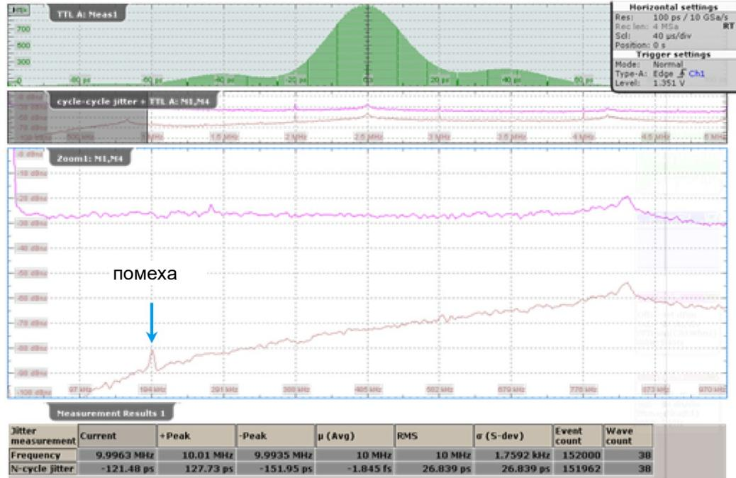
Рисунок 4-12 – Масштабирование спектров межтактового джиттера и осциллограммы
