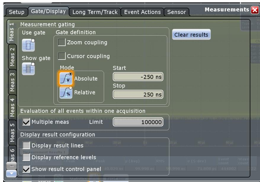
Рисунок 2-6 – Выбор множественных измерений ("Multiple meas") осциллограммы
