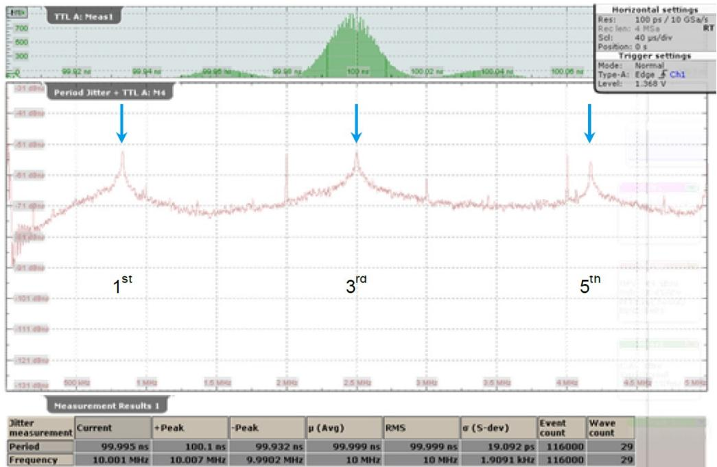
Рисунок 4-9 – Мастер Jitter Wizard: результирующий спектр джиттера периода
