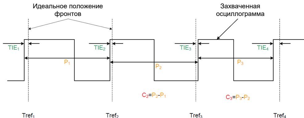
Рисунок 3-2 – Определение джиттера периода ( $P_1$ ), межтактового джиттера ( $C_2$ ) и джиттера искажения временного интервала (TIE)
