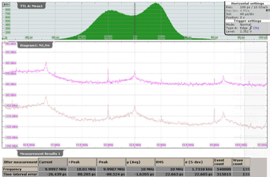
Рисунок 4-19 – Спектр джиттера TIE
