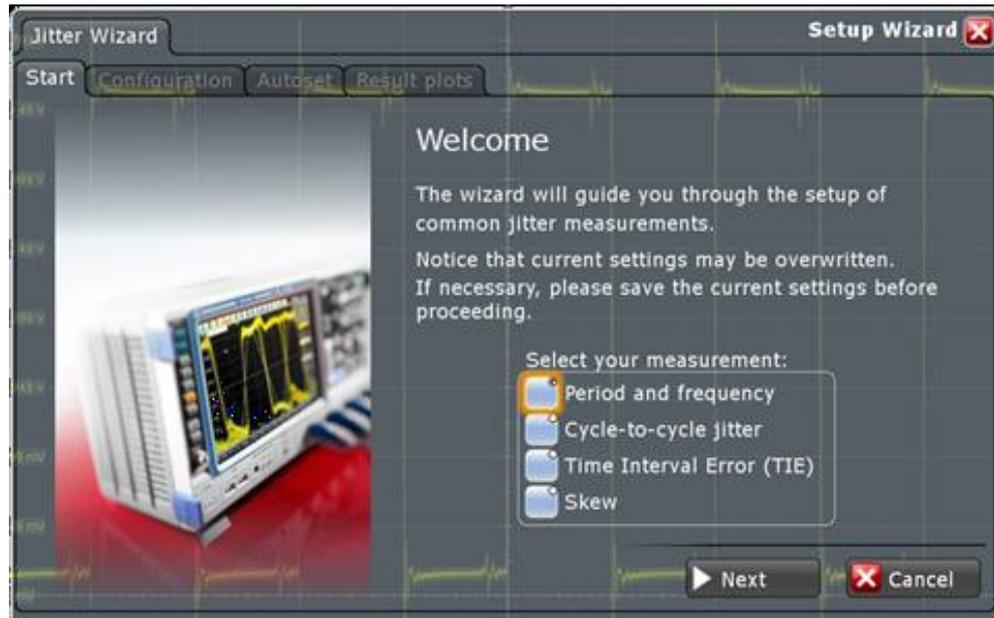
Рисунок 4-2 – Мастер Jitter Wizard опции RTO-K12: выбор типа измерений
