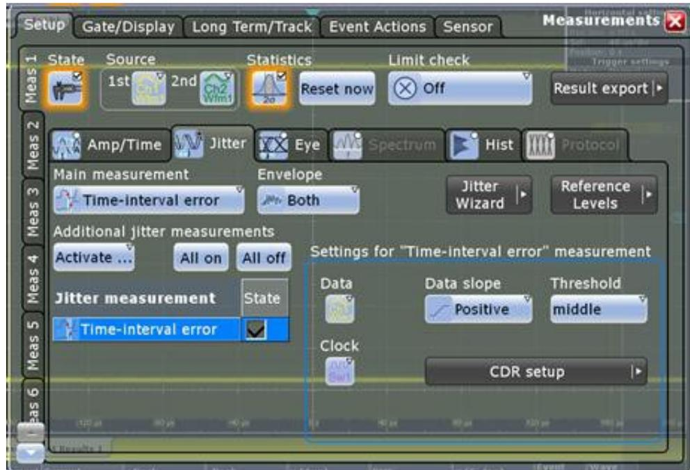
Рисунок 4-15 – Настройка измерений джиттера TIE
