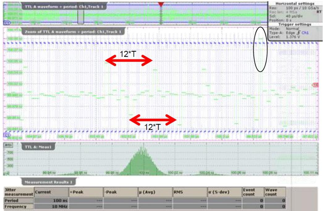
Рисунок 4-8 – Мастер Jitter Wizard: масштабирование результатов джиттера периода
