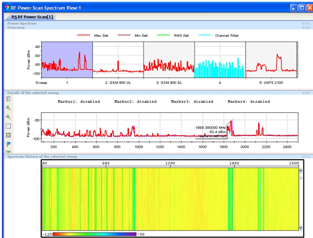
Figura 2 Medición del espectro completo de 80 MHz a 3/6 GHz
