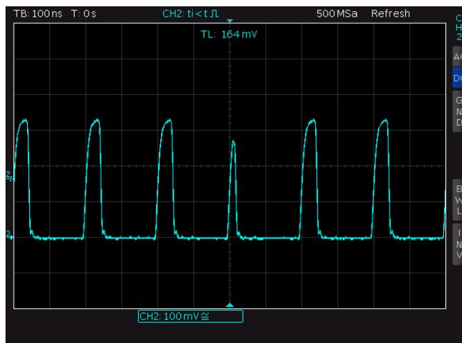
Abbildung 34: Triggerung auf einen Glitch mittels des Puls-Triggers
