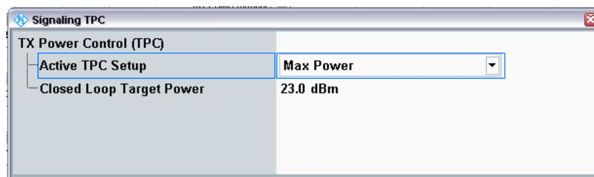
Fig. 3-7: Einstellen des DUTs auf maximale Uplink Power
