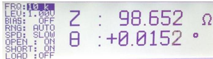
Bild 2-7: Scheinwiderstand und Phasenwinkel eines Widerstandes
