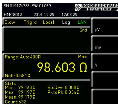
Bild 2-12: Displayanzeige einer Widerstandsmessung
