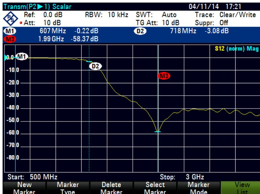
Bild 2-17: Messung der 3 dB Grenzfrequenz und der maximalen Sperrdämpfung an einem Tiefpassfilter
