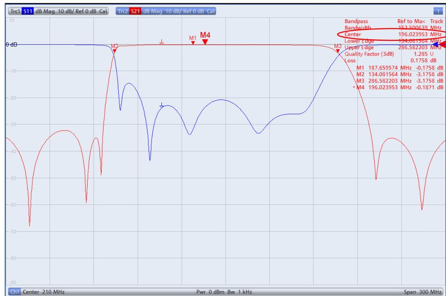
Bild 2-32: Anzeige aller relevanten Größen eines Bandpasses
