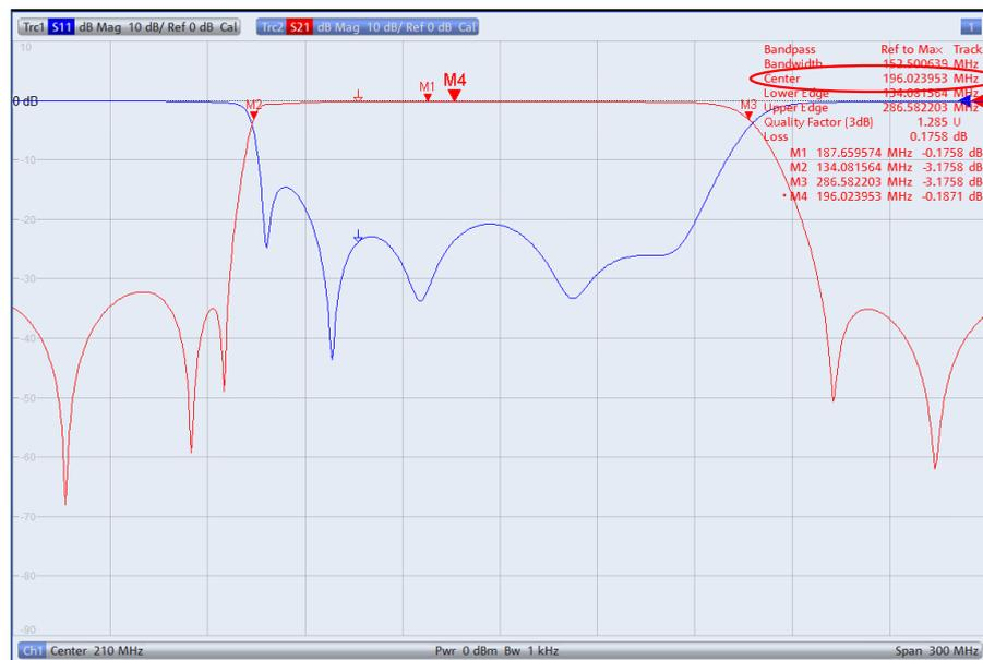
Bild 5-9: Anzeige aller relevanten Größen eines Bandpasses
