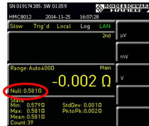
Bild 2-11: Anzeige des Offsetwertes nach der Kalibrierung
