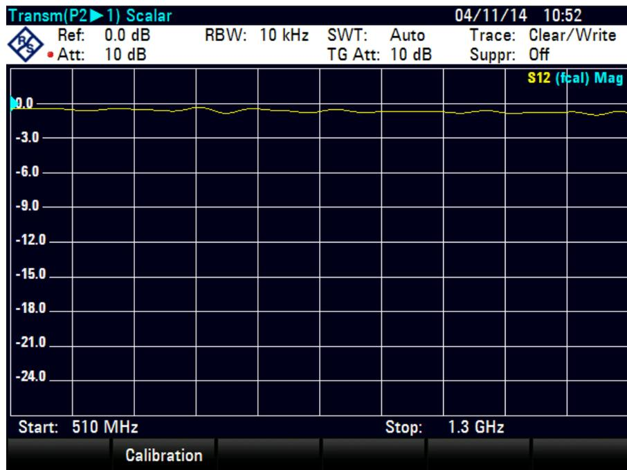
Bild 2-14: Messung einer Durchverbindung ohne Kalibrierung.
