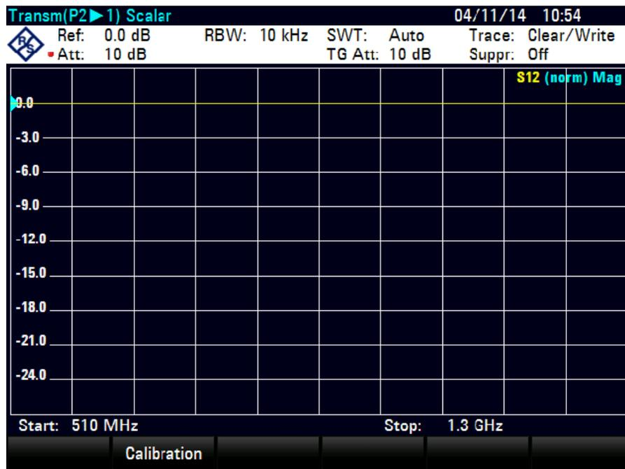
Bild 2-15: Messung einer Durchverbindung nach der Kalibrierung.
