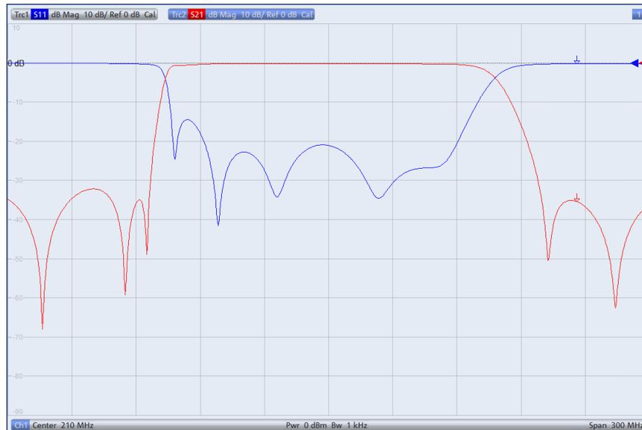
Bild 2-31: Reflexion und Transmission in einem Diagramm
