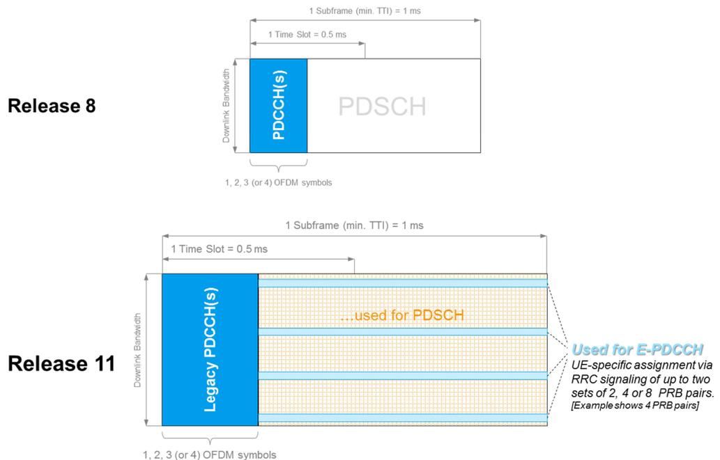
Fig. 2-12: PDCCH (Rel-8) versus E-PDCCH (Rel-11)
