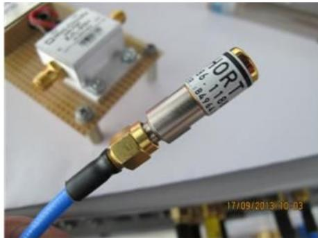
Калибровочные меры должны быть установлены на концах обоих кабелей для проведения калибровки, охватывающей все тракты (вплоть до ИУ).
