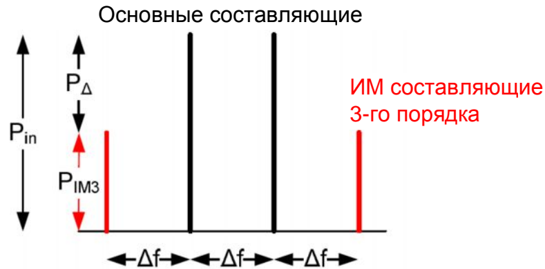
Рисунок 3 – Графическое изображение интермодуляционных составляющих третьего порядка и относящихся к ним параметров
