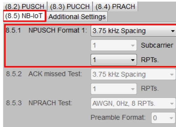
Fig. 3-227: Parameter for PUSCH test 8.5.1
