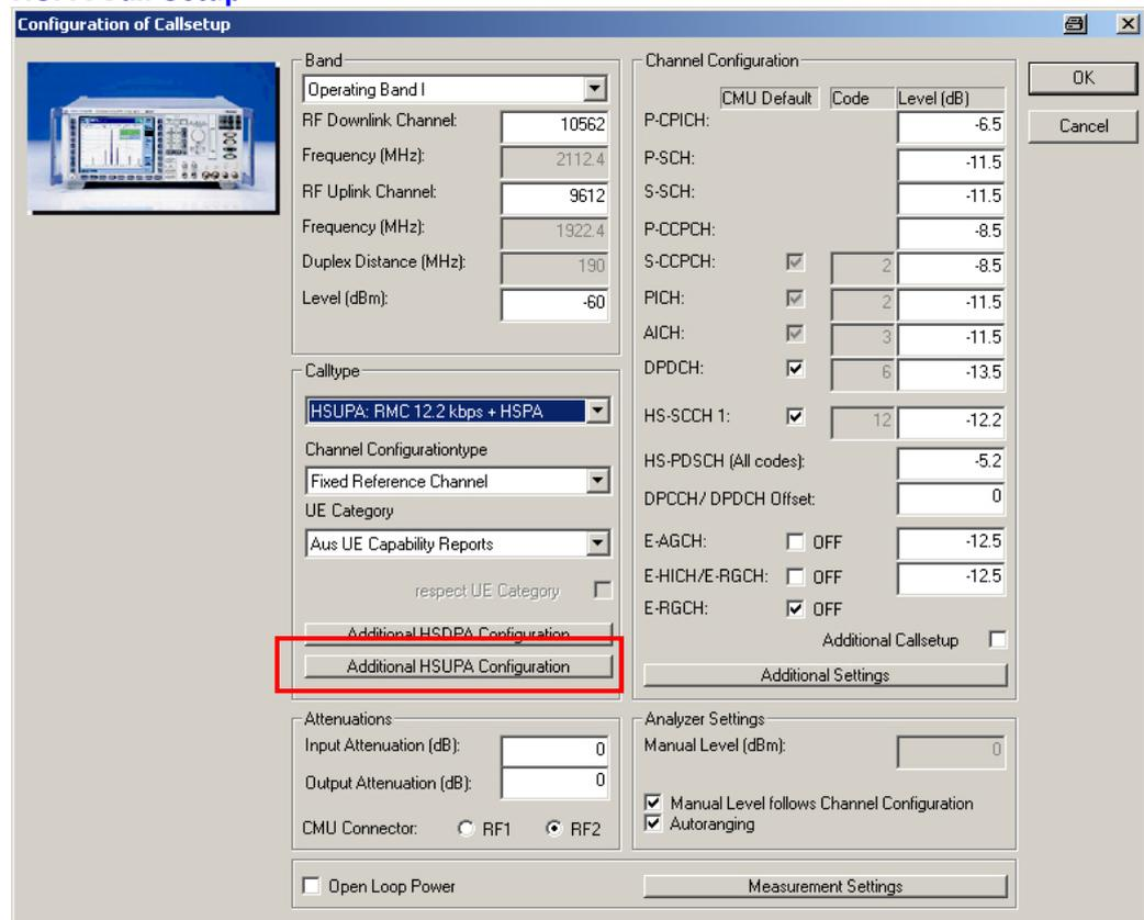
Fig. 53: HSPA Call Setup module
