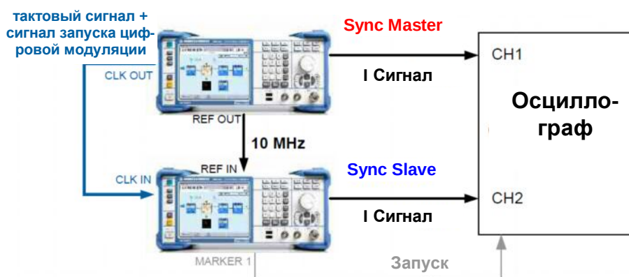
Рис. 5 – Схема измерений для временной подстройки модулирующих сигналов.
