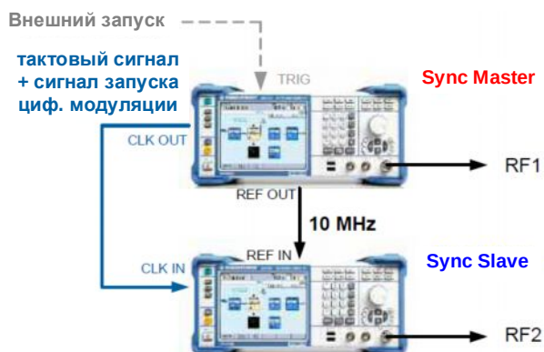
Рис. 3 – Система ведущий-ведомый с внешним запуском.
