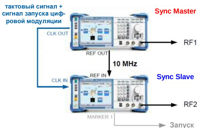
Рис. 4 – Схема ведущий-ведомый с внутренним запуском.
