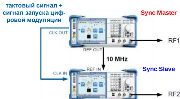
Рис. 1 – Схема ведущий-ведомый для двух генераторов SMBV.
