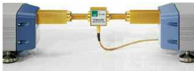
Рис. 4.16: Усилитель, установленный между двумя преобразователями R&S®ZVA-Z110 (ТУ предоставлено Фраунгоферовским Институтом Прикладной Физики твердого тела, Фрайбург/Германии)
