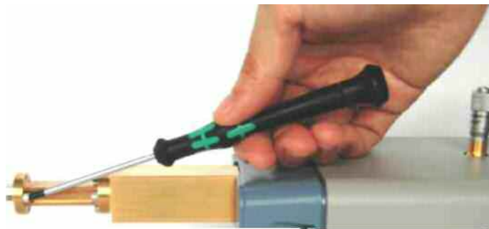
Рис. 4.5: Соединение волноводного фланца к другому, например, к TУ
