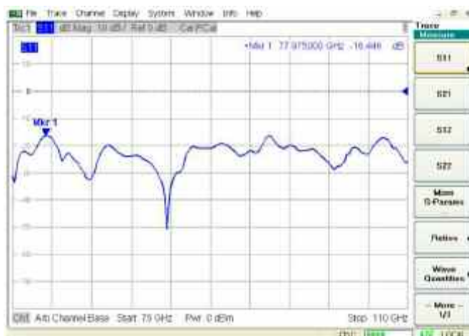
Рис. 4.12 Измерение возвратных потерь (коэффициента отражения) на ВЧ входе смесителя R&S®FS-Z110
