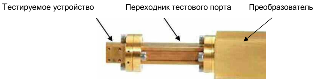
Рис. 2.2: Рекомендуемая конфигурация для подключения ТУ к преобразователю
