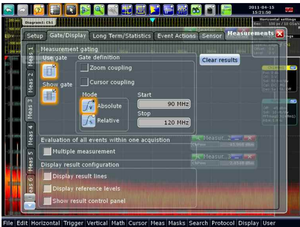
Рисунок 12 – Экран настройки стробируемого измерения мощности сигнала (Measurement 3)
