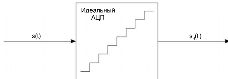
Рисунок 1 – Схема идеального аналого-цифрового преобразователя
