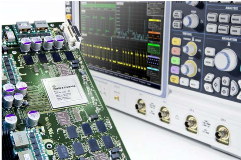
Figure 8: L'ASIC du RTO assure un temps mort très court avec l'intégration d'un traitement de très haut niveau
