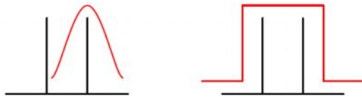
Рисунок 6 – Двухтональный вариант, показанный с АЧХ аналоговых ПЧ-фильтров. Слева: узкополосный RBW-фильтр, справа: широкополосный фильтр для подавления помех от зеркальных каналов.
