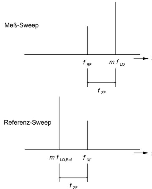
Bild 2-3: Signalidentifizierung mit Hilfe eines Referenz-Sweeps
