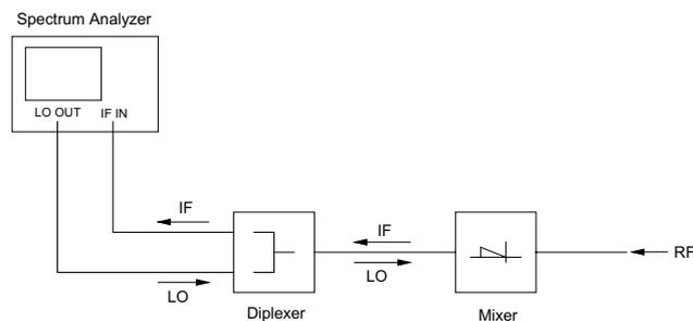
Bild 2-1: Meßaufbau für Verwendung von externen 2-Tor-Mischern.
