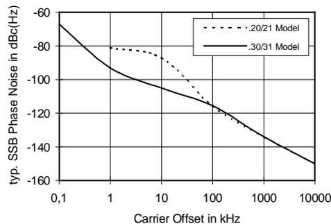
Bild 2-5: Typisches Einseitenband-Phasenrauschen des Lokaloszillators des FSEM / FSEK
