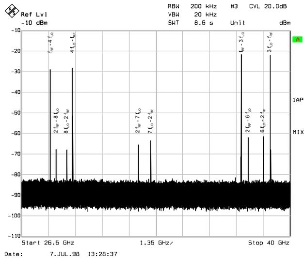
Bild 2-2: Spektrum eines 39-GHz-CW-Signals aufgenommen mit einem Oberwellen-Mischer.
