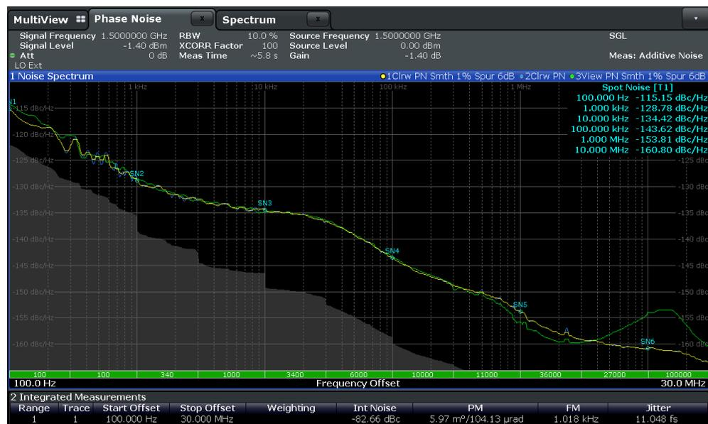
**Fig. 3-18: Phase Noise Measurement of a DDS**
